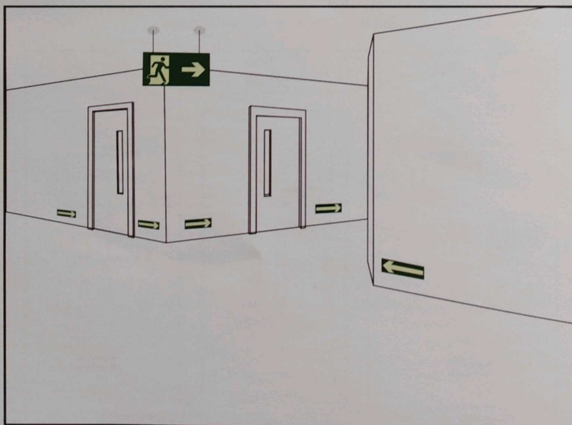
Sinalização de saída perpendicular ao sentido da fuga, em dupla face
