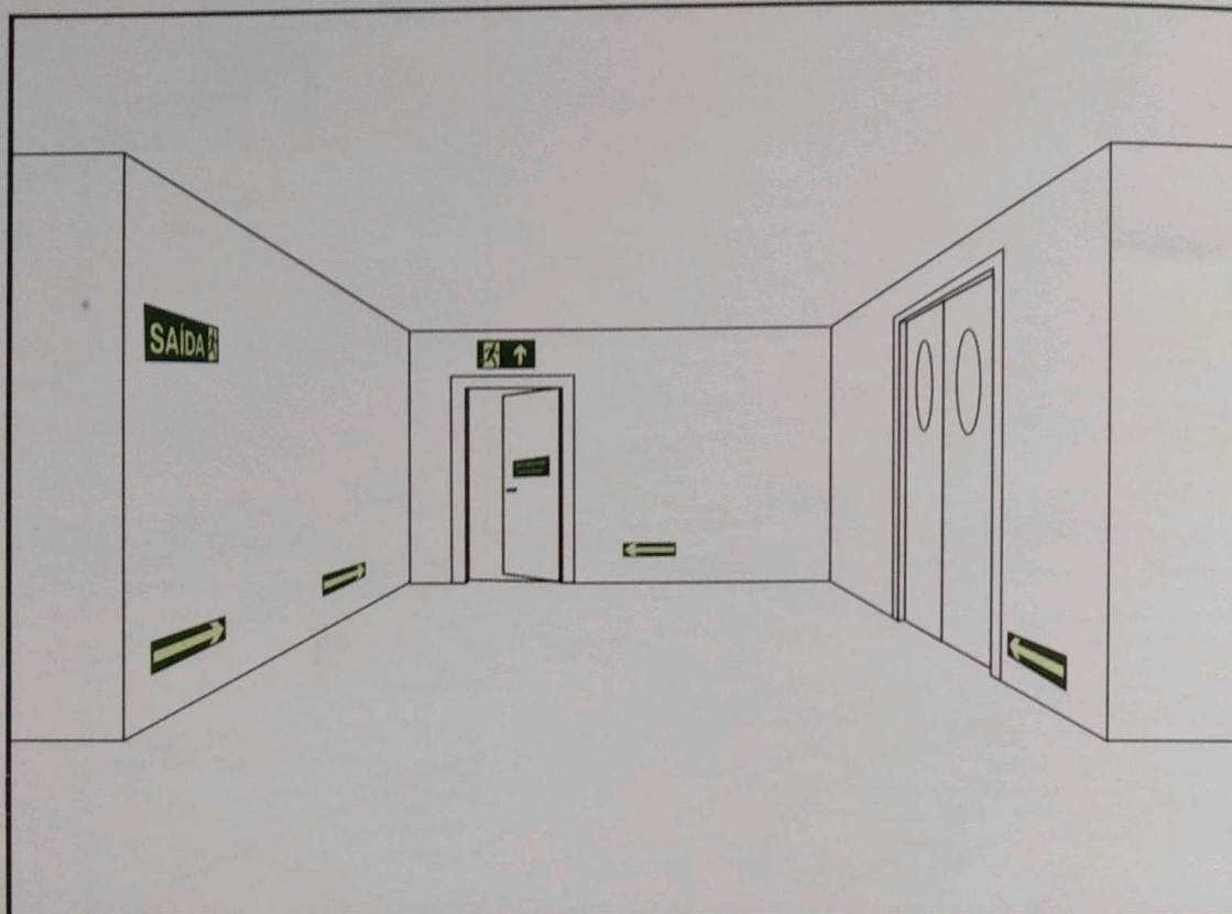
Sinalização de saída sobre porta corta-fogo
